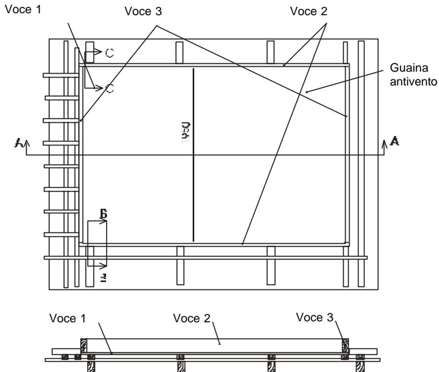
Figura 3.1: Struttura del tetto con il collettore inserito
