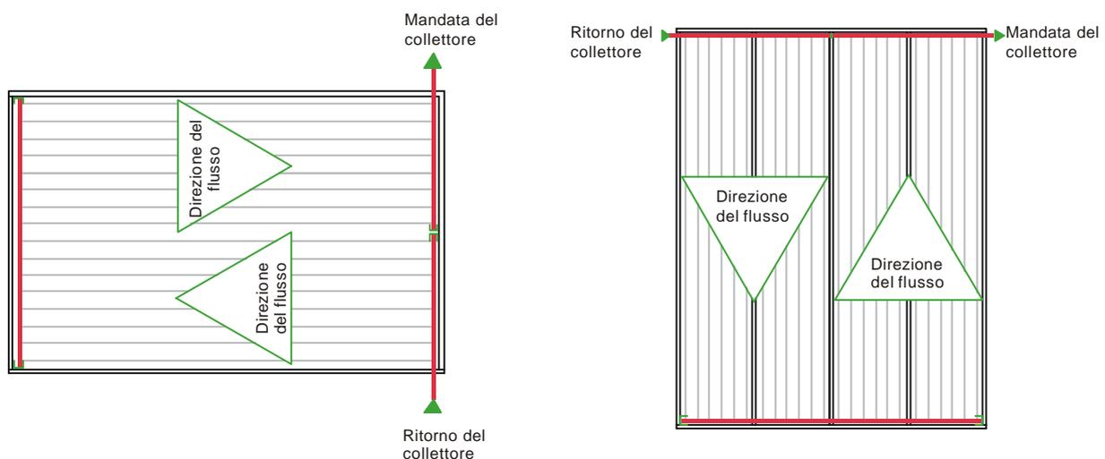
Figura 5.1: Montaggio orizzontale e verticale delle strisce di assorbimento
