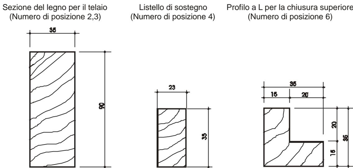
Figura 4.1: Profili di legno per la fabbricazione del collettore
